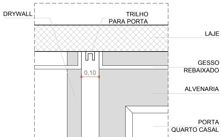
DETALHE 01 TRILHO DA PORTA DE CORRER ESCALA 1:25
